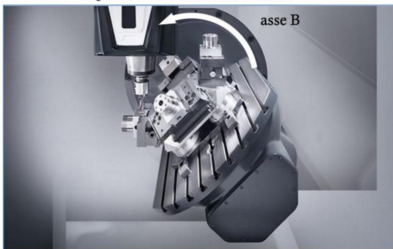
Fig. 131. Asse B in un centro di lavoro
