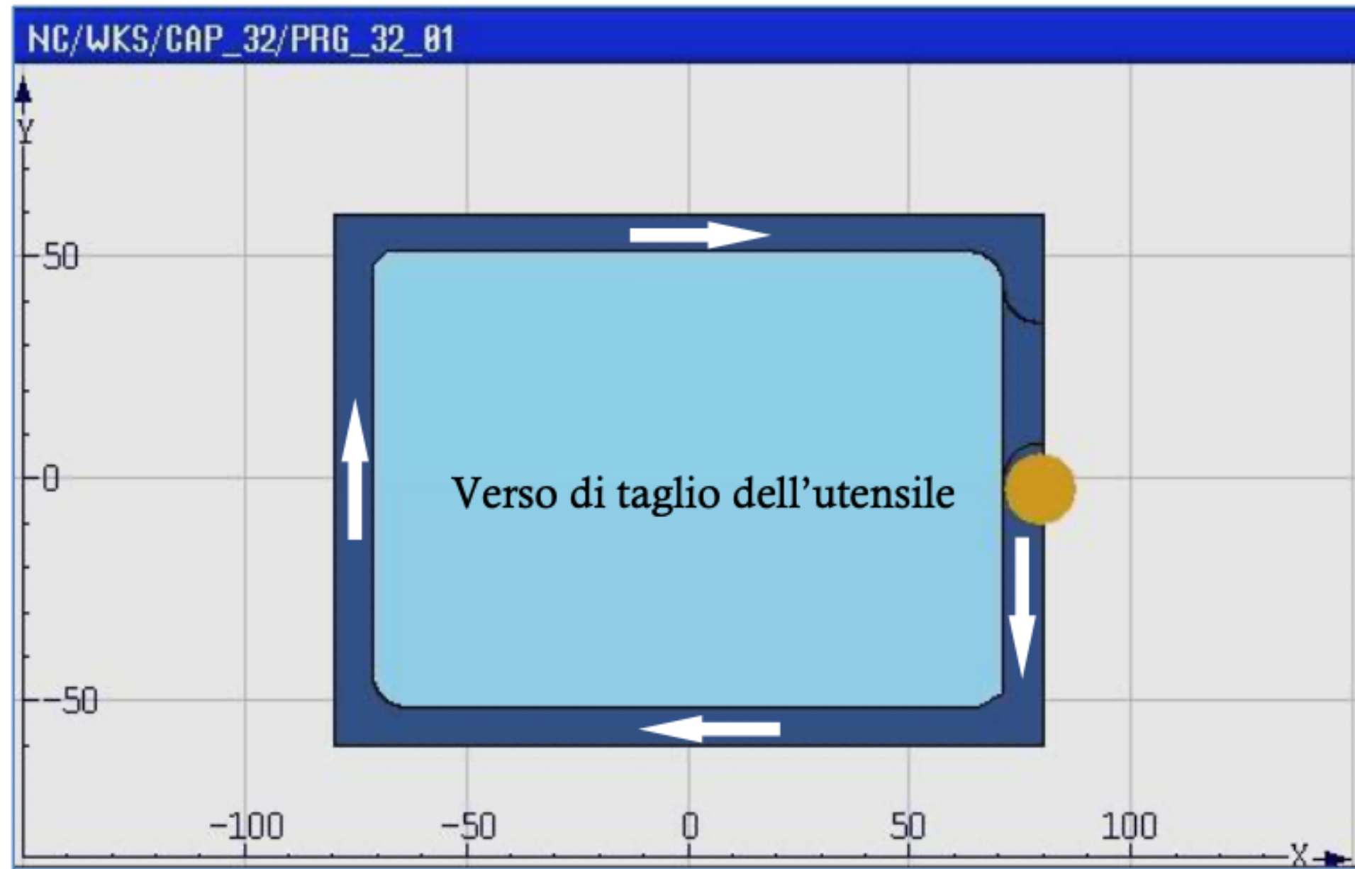
Fig. 148. Realizzazione del profilo esterno
