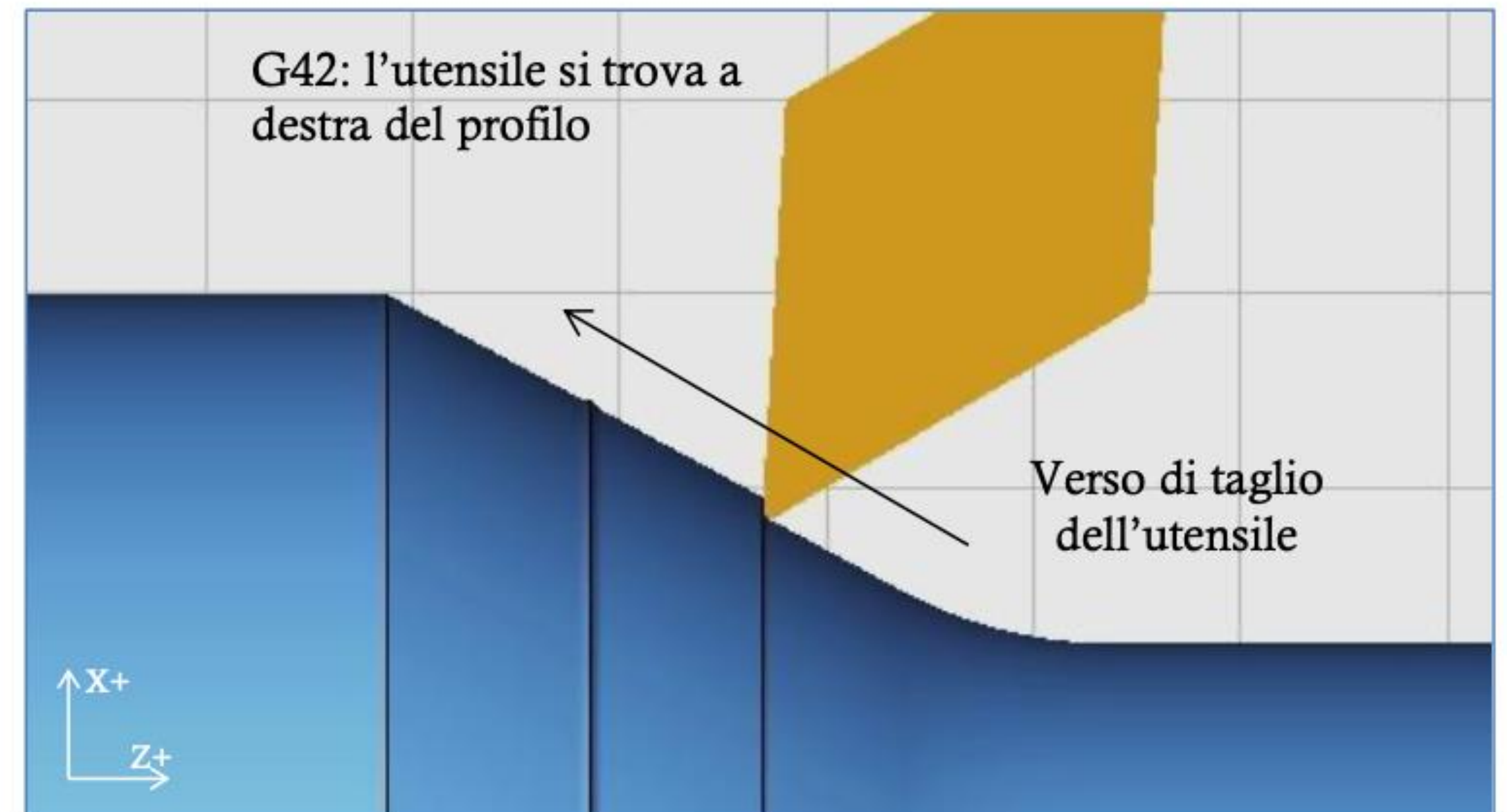
Fig. 119. G42: utensile di raggio 0.2, quadrante 3, a destra del profilo
