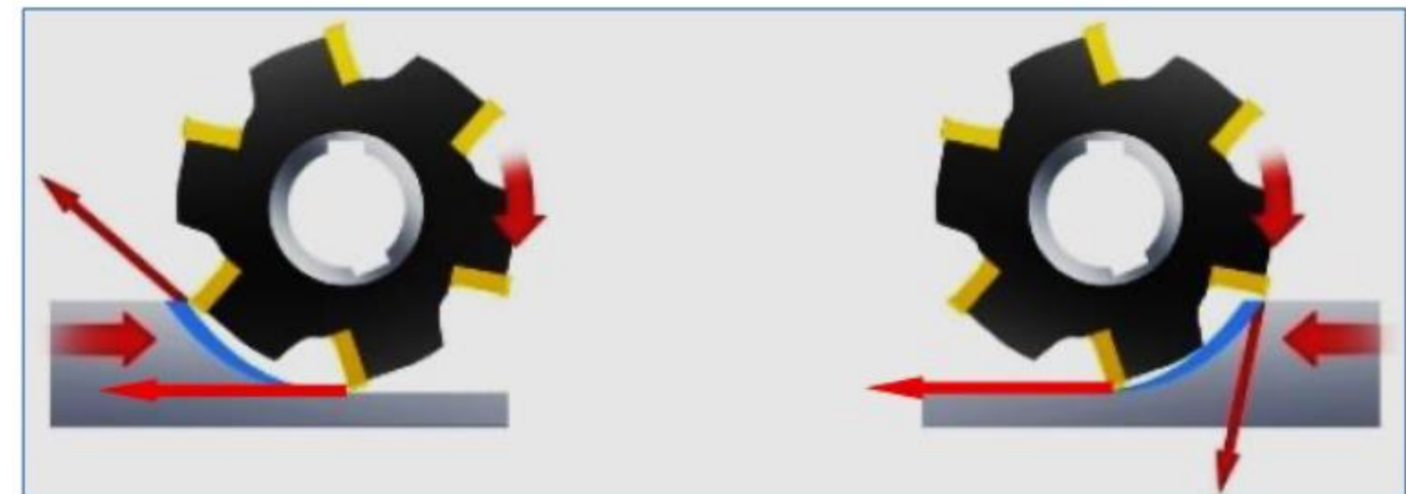
Fig. 153. Verso di taglio discorde (a sinistra) e verso di taglio concorde (a destra)
