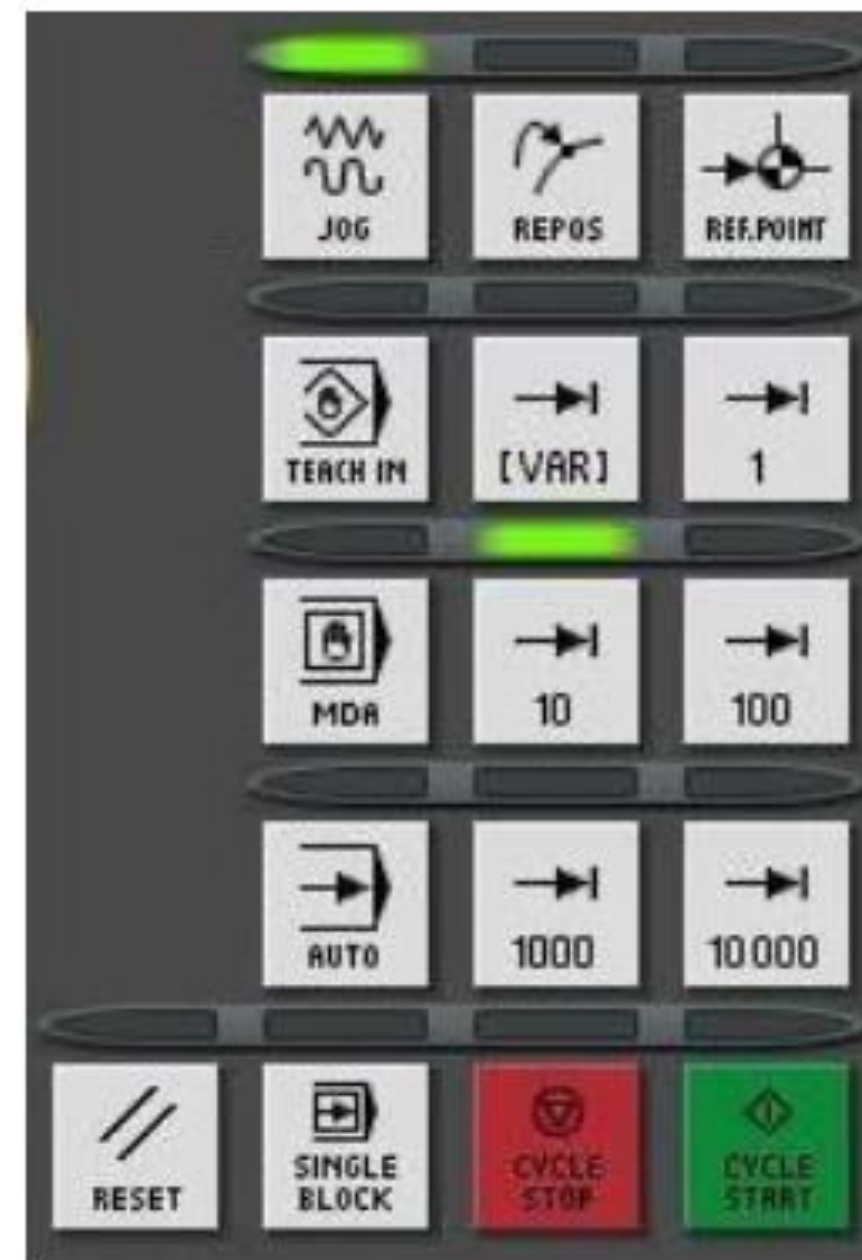
Fig. 57. Pulsanti per la selezione dell'avanzamento manuale per incrementi
