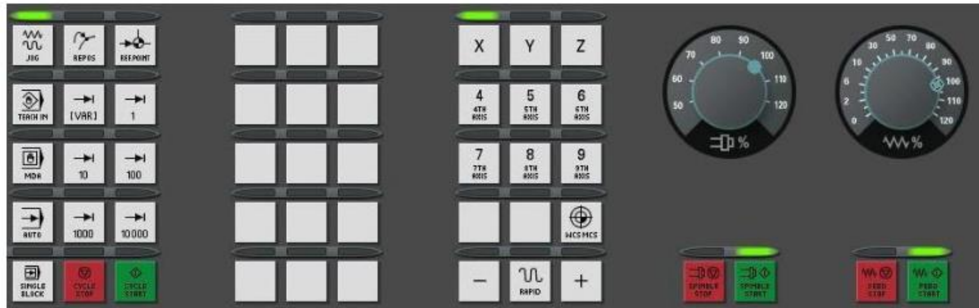
Fig. 56. Pulsanti per la selezione dell'avanzamento manuale continuo
